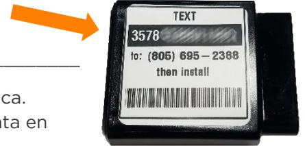
**Paso 2:** Enchufa el localizador gps en la conexión OBD del vehículo. Suele estar ubicada en la zona de los pies del conductor, ya sea debajo del volante, o cerca de la caja de fusibles.
